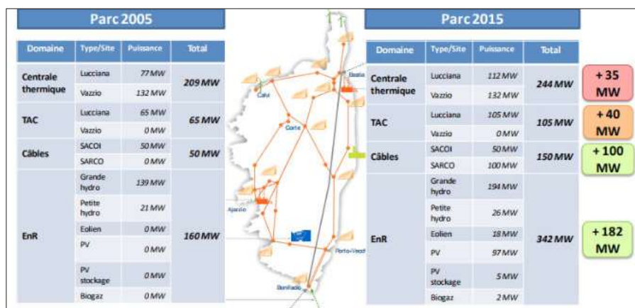
> Tableau et schéma : Évolution du parc électrique de la Corse (Source : EDF)
